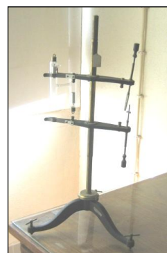
fig. 4 – Suporte para espectroscopia com tubo de Geissler (MCUL) 8
